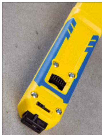
Auf der anderen Seite befindet sich die Schnittiefeinstellung der Hakenklinge
