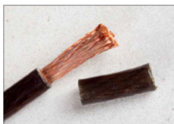
Sauber abisoliert, so arbeitet das Messer bei all unseren Tests
