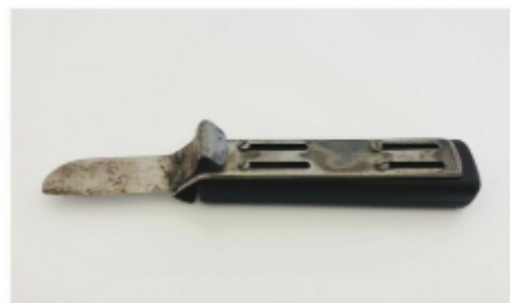
Der Prototyp: Eines der ersten von Josef Krampe entworfenen Kabelmesser mit gerade Klinge.
